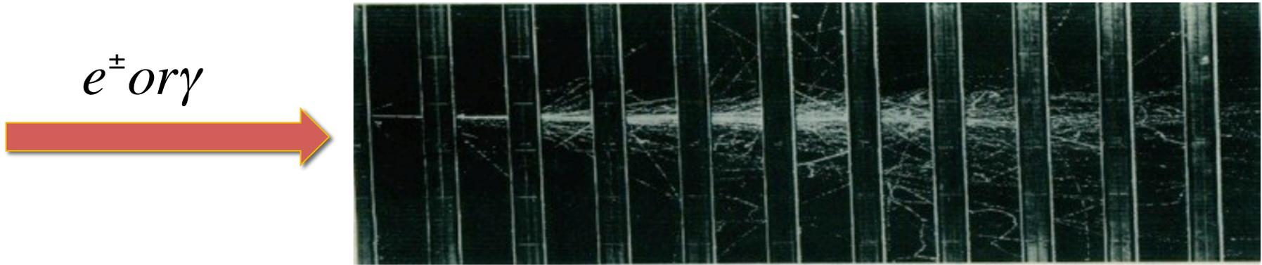
In dense material,  $R_{\text{Moliere}} \sim 10\text{cm}$ :
